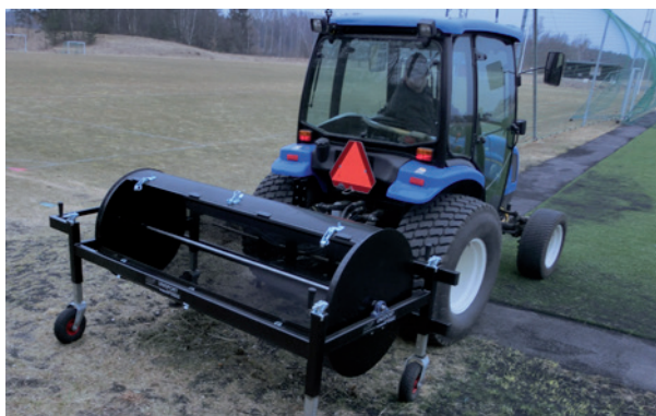
När granulatrensaren ska fyllas med granulat öppnas enkelt en lucka
